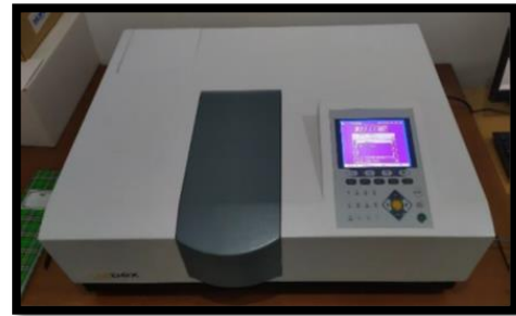
Gambar Lampiran 10. Pengukuran nilai absorbansi dengan spektrofotometer UV-Vis
