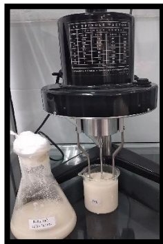
Gambar Lampiran 7. Pengukuran viskositas peaghurt dengan viskometer Brookfield LV
