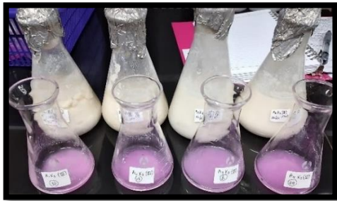
Gambar Lampiran 5. Hasil kadar asam laktat peaghurt dengan perbedaan perlakuan kombinasi jenis starter BAL dan jenis susu kacang setelah dititrasi dengan NaOH 0,1 N
