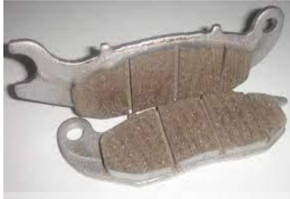
**Gambar 2.3** Kampas Rem Asbestos
