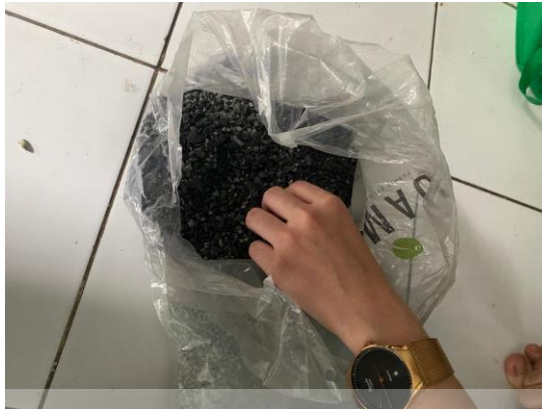
Proses Pencampuran Zeolit dan Karbon Aktif
