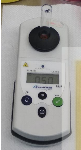
Gambar Lampiran 2. DensiCHEK (Alat untuk mengukur kekeruhan inokulum)
