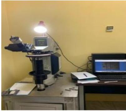
Gambar 2.12 Mesin Uji Kekerasan
