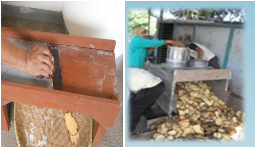
Gambar 11. Pengirisan umbi iles-iles secara manual dan dengan mesin
