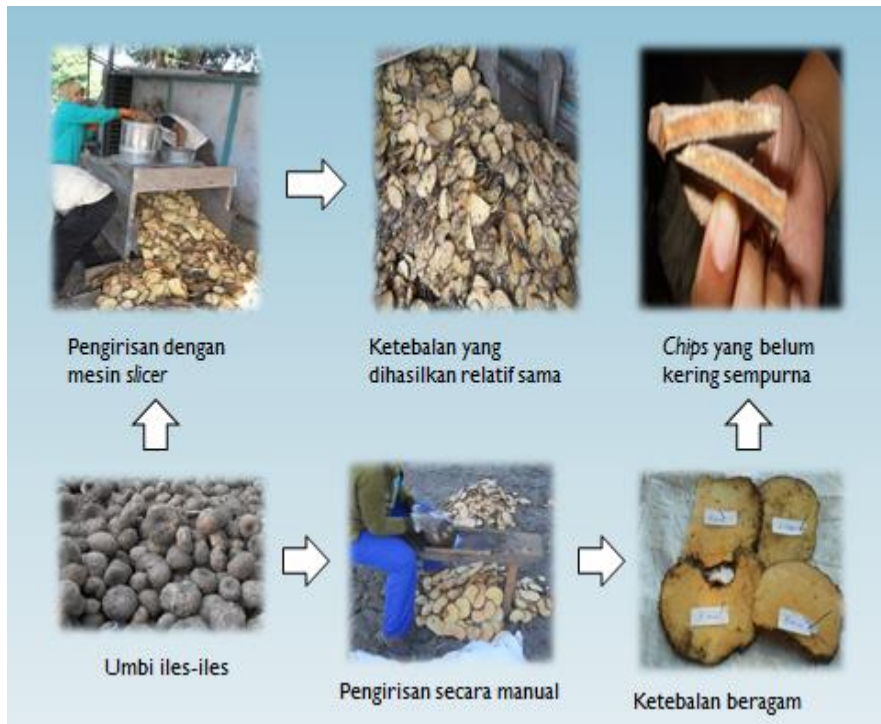
Gambar 12. Proses pembuatan chips iles-iles dari umbi dengan mesin
