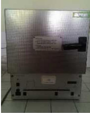
**Gambar 3.4** *Furnace* untuk proses *annealing* TLD-10
