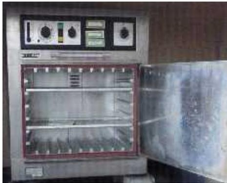
**Gambar 3.3** *Oven* untuk *annealing* TLD
