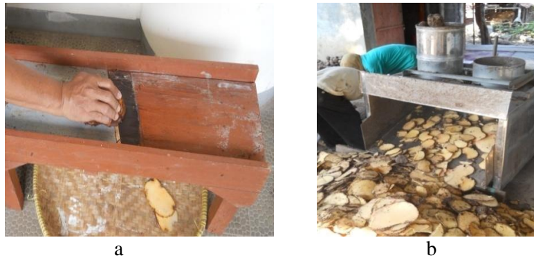
Gambar 12 Pengirisan umbi iles-iles. a) secara manual ; b) menggunakan mesin
