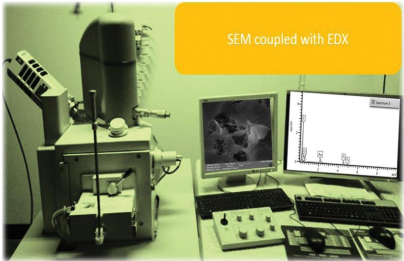
GAMBAR 1.1 Foto instrumen scanning electron microscopy (SEM) dengan SEM dan citra energydispersive X-ray spectroscopy (EDX).
