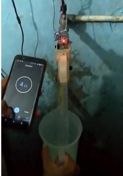
Gambar 4.15. Pengujian perbandingan volume keluar fluida terhadap sudut bukaan katup
