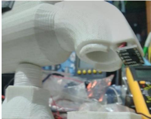
Gambar 3.13. Kedudukan *laser ranging sensor*
