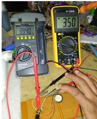
**Gambar 4.2. Pengujian rangkaian penyearah dioda *rectifier***
