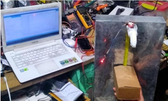
Gambar 4.11. Pengujian ketepatan sensor membaca jarak benda
