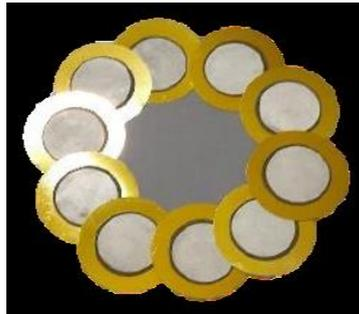
**Gambar 2.2. Elemen Piezoelektrik [17].**
