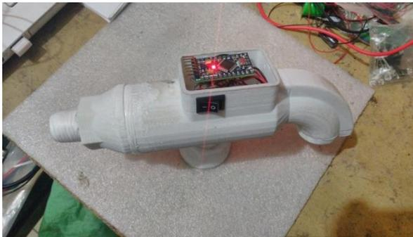
Gambar 3.11. Kontruksi tempat komponen penyaluran energi dan pengendalian otomatis
