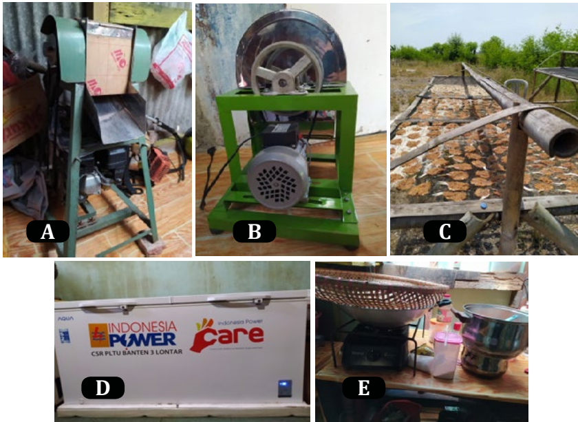
Gambar 7. Alat-Alat Produksi Pengolahan Pangan Ikan Japuh: A) Mesin Pemotong Kripik Ikan Japuh, B) Mesin Penghancur Daging Ikan, C) Pengeringan Manual untuk Dendeng Ikan, D) Freezer untuk Penyimpanan Dendeng dan Kripik Ikan, E) Alat Masak Kripik dan Dendeng
