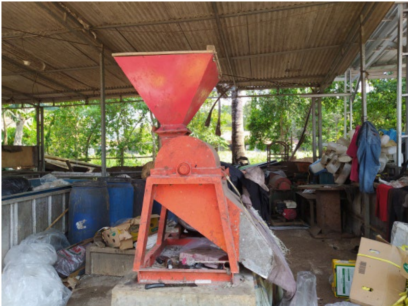
Gambar 8. Mesin Penepung Cangkang Kerang
