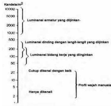
Gambar 2.4 Skala luminansi untuk pencahayaan interior. Sumber : (SNI, 2001)
