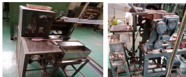
Gambar 12. Mikser pengaduk bahan baku beras analog
