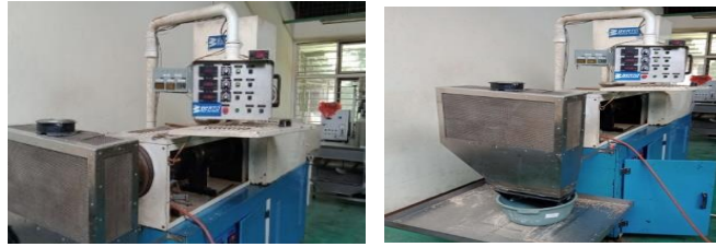
Gambar 13. Mesin ekstruder pencetak beras analog jenis twin roll
