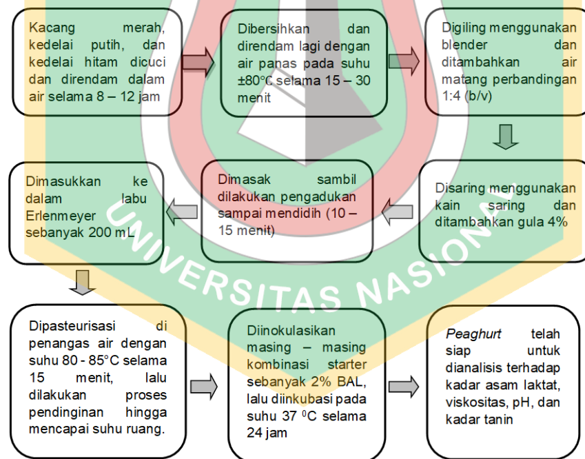
Gambar 1. Diagram alur proses pembuatan peaghurt dari susu kacang merah, kedelai kuning, dan kedelai hitam
